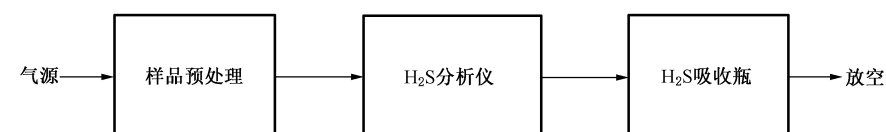
图 2 激光法硫化氢分析仪的分析流程
